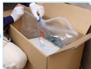
4. スライダーでチャックを閉めて密封が一瞬で完了。人力で確実に無酸素パックが作れる。
