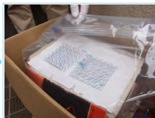
2. Ageless® ZP 3000とAgeless-eye®を包装内に装填する。酸素検知剤は外側から見える位置にテープ等で貼り付ける。
